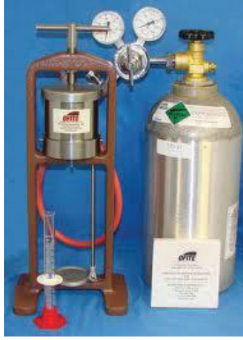
الشكل (6): جهاز قياس رشح سائل الحفر مع اسطوانة الغاز و منظم الضغط.[4]
