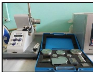
الشكل ( 2 )جهاز قوة التمزق [8,4]
