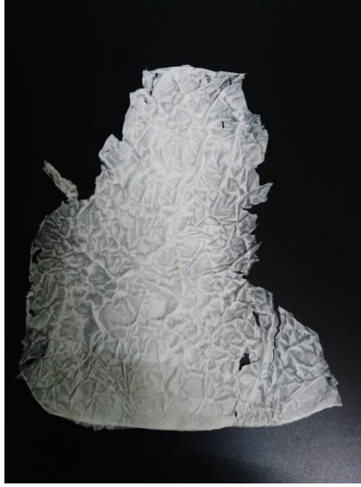
الشكل (3) : الشبكة النانوية الناتجة عن عملية الغزل الكهربائي
