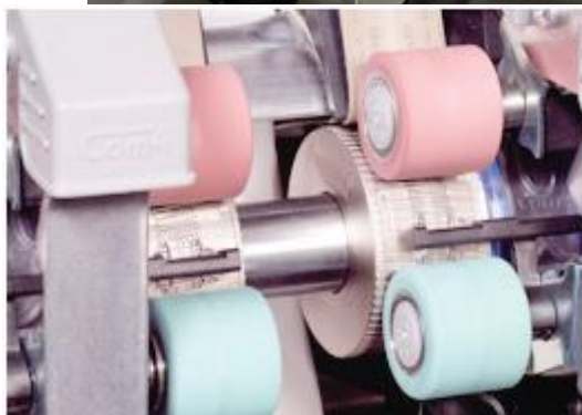
الشكل 6 صورة مكونات نظام الغزل المتراص لشركة ريتر السويسرية
