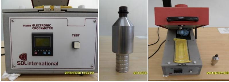
الشكل (5): جهاز اختبار الثباتية للاحتكاك المستخدم ورأس الحكّ ولوحة التحكم الخاصة به.
