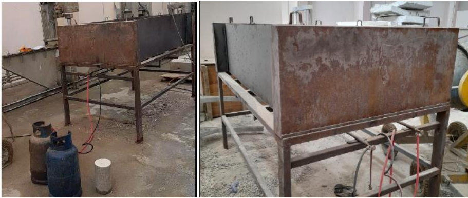
الشكل (15) فرن الغاز المصمم لإجراء الحريق
