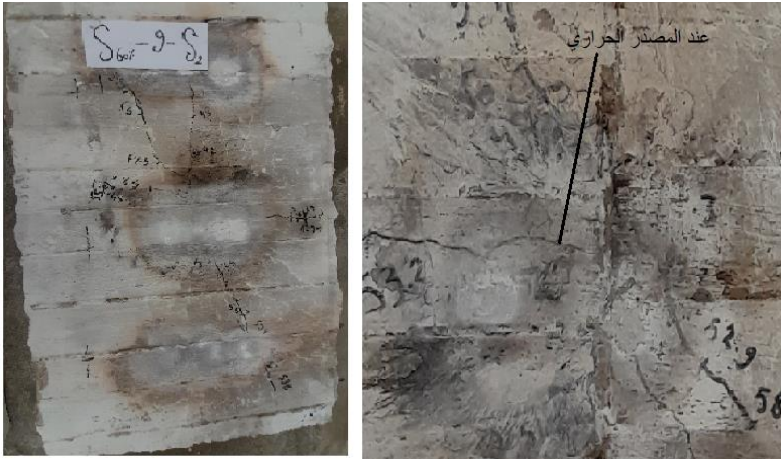
الشكل (26) الشقوق وتفتت الطبقة السطحية لبلاطة مبردة بالماء
