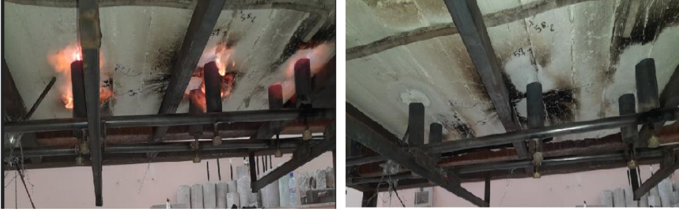
الشكل (19) لهب النار موزع على ستة شعلات حرارية
