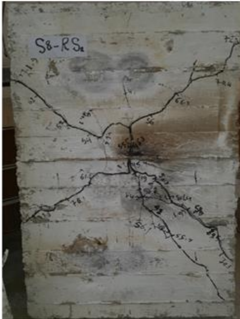
الشكل (27) أنماط الشقوق في البلاطات المتضررة بلهب النار المباشر
