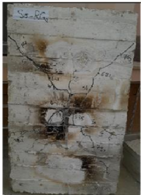
الشكل (27) أنماط الشقوق في البلاطات المتضررة بلهب النار المباشر
