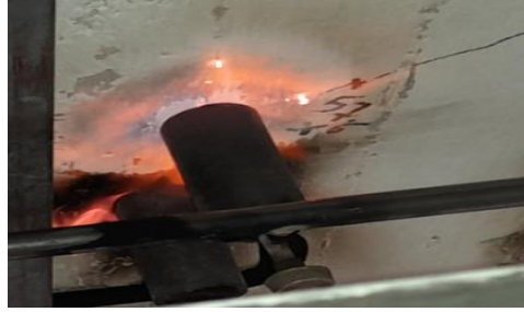
الشكل(24) توهج السطح البيتوني عند المصدر الحراري
