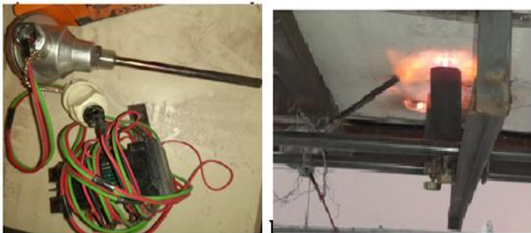
الشكل (17) الحساس المستخدم لقياس درجة حرارة اللهب
