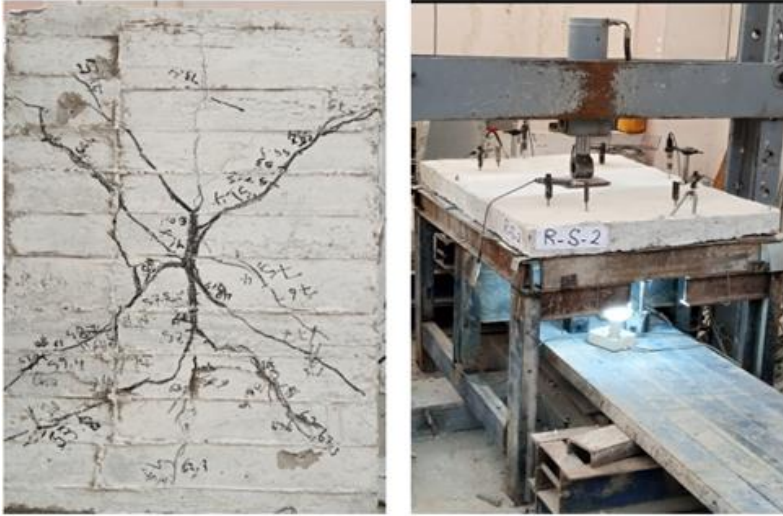
الشكل (7) كسر أحد البلاطات البيتونية المسلحة لتأكد من نظام التحميل
