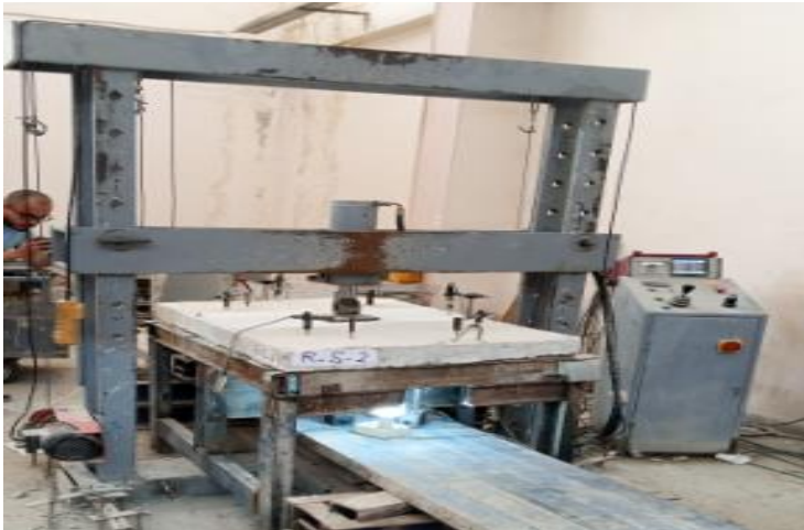
الشكل (8) جهاز كسر العينات ونظام التحميل
