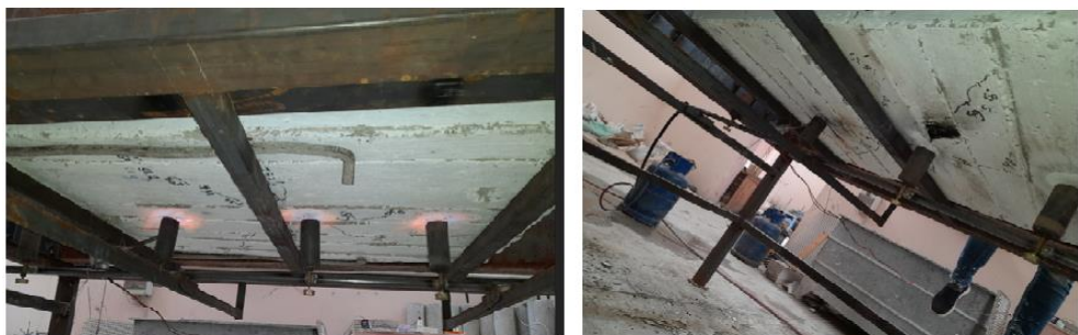
الشكل (18) لهب النار موزع على ثلاث شعلات حرارية
