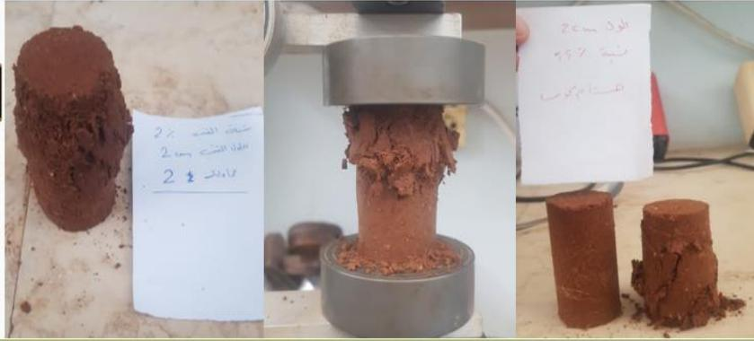
الشكل (20) : أشكال انهيار عينات الضغط الحر.
