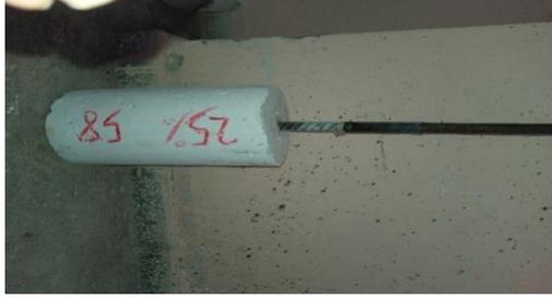
الشكل (2) انهيار بانسحاب فولاذ التسليح
