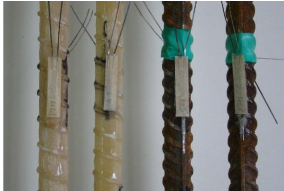
الشكل (7): شكل القضبان الزجاجية GFRP والفولاذية مبين عليها كيفية لصق حساسات التشوه.
