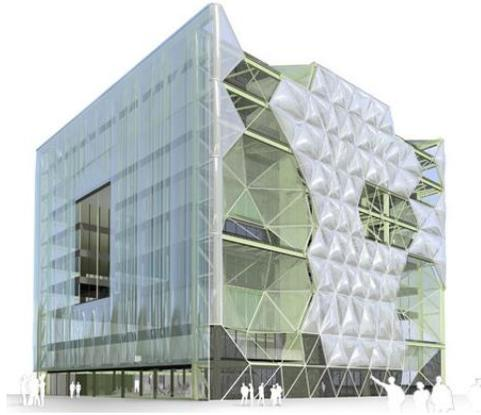
الشكل (5) استخدام جدران مزدوجة من الأقمشة المملوءة بالهواء مبنى Media-TIC المصدر: [12]
