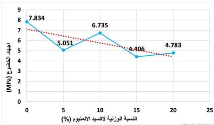
الشكل 14: تغير إجهاد الخضوع للمواد المركبة تفلون/ أكسيد الألمنيوم بدلالة النسبة الوزنية لأكسيد الألمنيوم.
