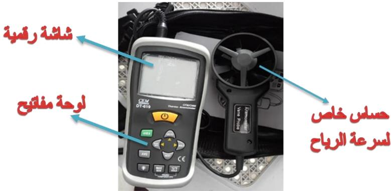
الشكل (13) جهاز قياس سرعة الهواء (CEMDT-619)
