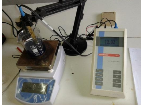
الشكل (7) يوضح حوض الترسيب ومقياس درجة الحموضة المستخدم
