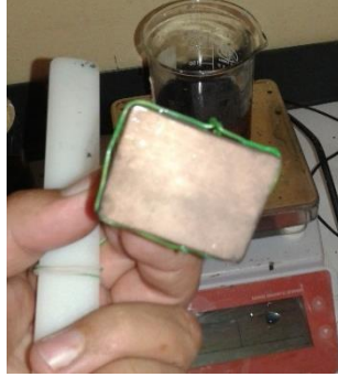
الشكل (8) يوضح شكل العينة البلاستيكية بعد تلبسها بطبقة نحاس
