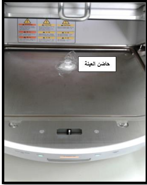
الشكل (21) مكان توضع العينة في جهاز (EDX).
