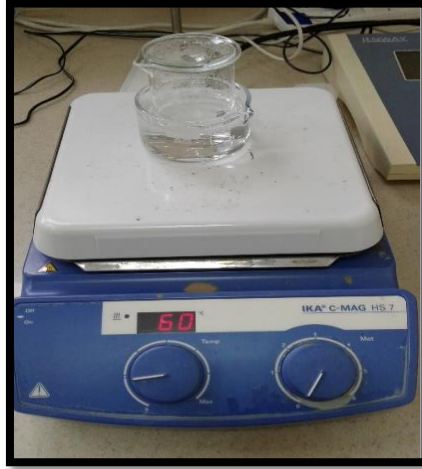
الشكل (17) غمر العينة (6) بمحلول (NaOH 5M).
