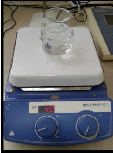
الشكل (18) غمر العينة بمحلول (Ca Cl 2 100mM).
