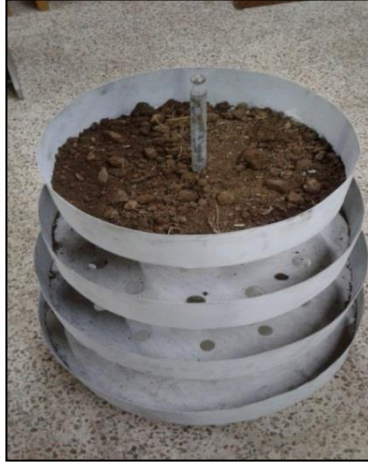
الشكل(1): جهاز قياس درجة تفتيت السماد/مخبري
