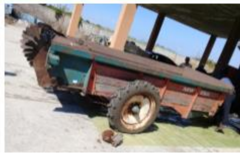
الشكل(2): آلة نثر السماد العضوي
