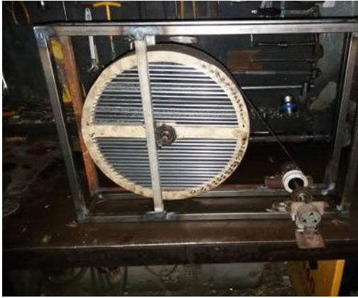
الشكل (2) الدولاب المجفف المصمم لإزالة الرطوبة
