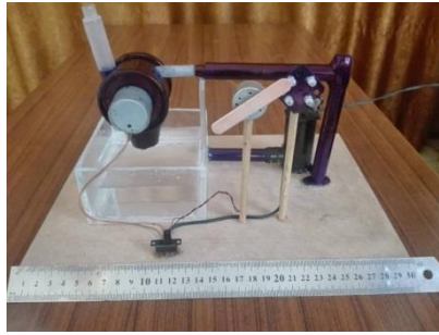
الشكل (1) النموذج المقترح لعنفة بلتون
