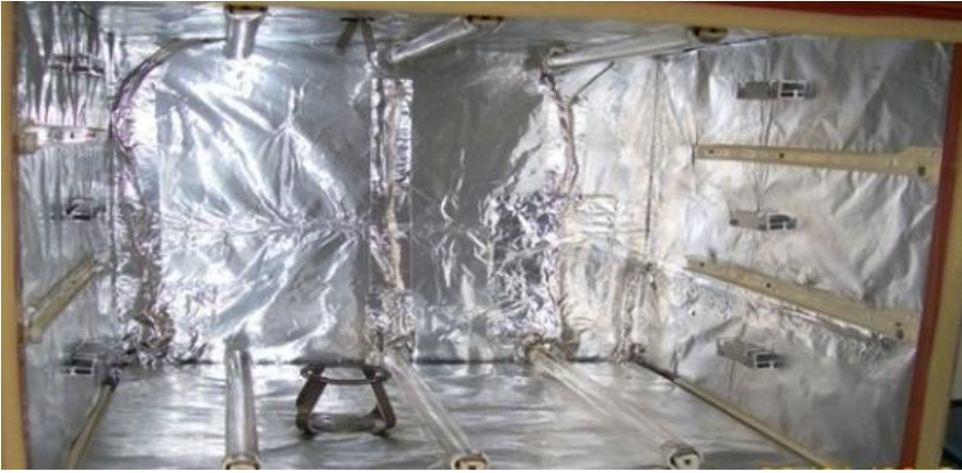
الشكل (6) الجهاز المصدر للأشعة فوق البنفسجية
