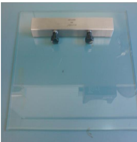
الشكل (5) صبّ المحلول على لوح زجاجي بمساعدة مديّة الصب
