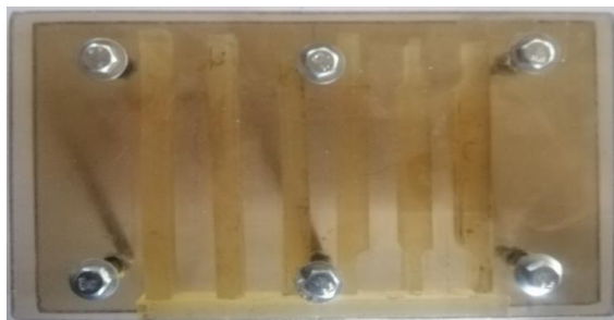
الشكل 5-2: قالب تحضير العينات للمعالجة الإشعاعية
