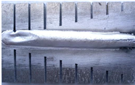
الشكل (7): وصلة لحامية خضعت للاختبار بطريقة اللحام CMT
