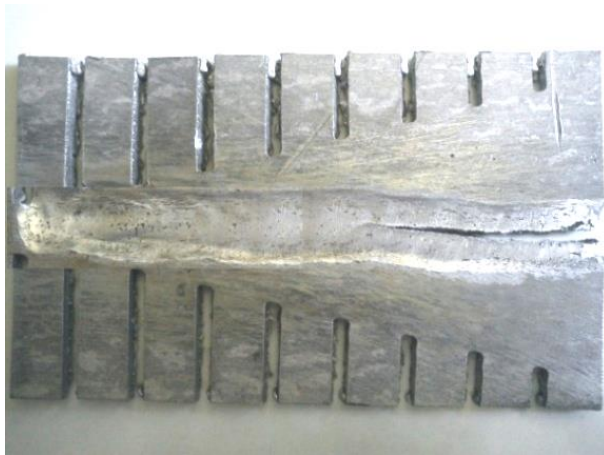
الشكل (6): وصلة لحامية خاضعة للاختبار Houldcroft (آلة اللحام الـ TIG)
